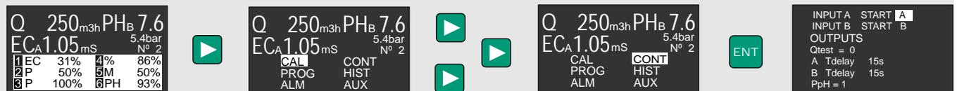
Regulación de pH por control PIQ (PI condicionado al caudal). Solamente salidas tipo A.
