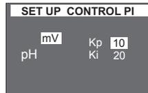
Contrôle Redox, constante de proporcionalité pour le contrôle PI
