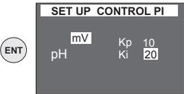
Contrôle Redox, constante integrale pour le contrôle PI
