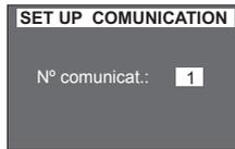
Identificación del equipo para conexión a una red RS485
