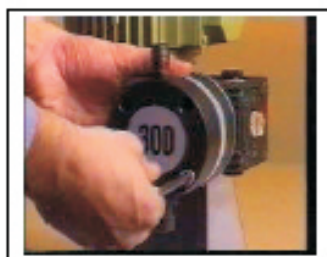
1. Desmontar el cilindro sacando los cuatro tornillos Allen
