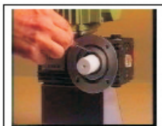
5. Con un objeto punzante limpiar los restos de fija tornillos de la rosca del vástago
