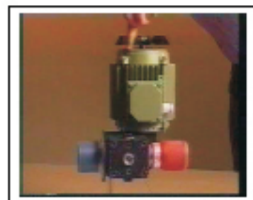
3. En faisant tourner manuellement le ventilateur, placer le piston le plus près possible du module
