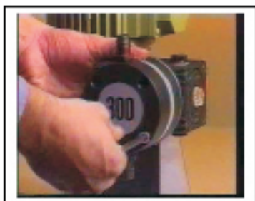
1. Démontez le cylindre en enlevant les quatre vis allen.
