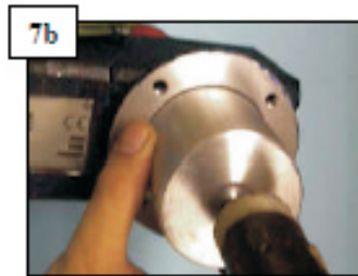
7b También se puede introducir la junta torica mediante un útil como muestra la foto
